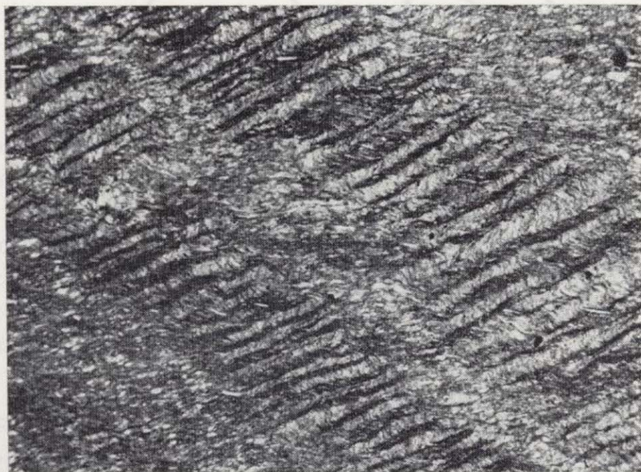
Figura 8.—Filita. Aspecto textural de micropliegues de tipo kink-band que marcan la S_3 , sobre la esquistosidad principal. S_2 . N// \times 312 .
